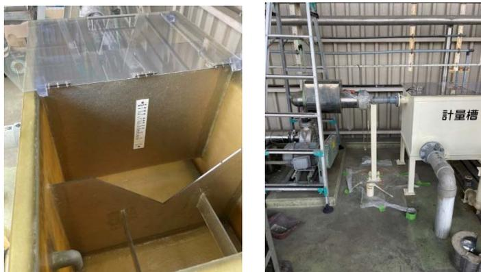
実例③：金箔を細かく裁断する破碎機を製作しました。金箔が静電気でくっつくため、ケースは木箱で作りしました。
